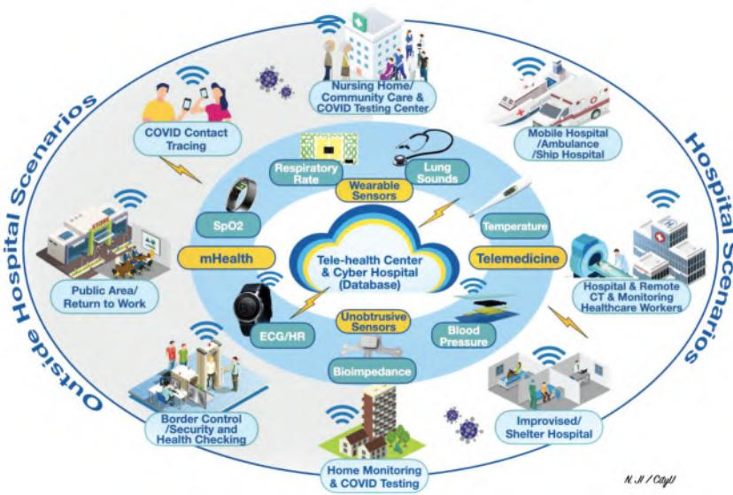
在大流行病期间，可穿戴式设备、无扰式传感器和远程医疗系统的应用场景。(论文在《IEEE生物医学工程综评学报》发表，题为《可穿戴传感和远程医疗技术在冠状病毒大流行的潜在应用》“Wearable Sensing and Telehealth Technology with Potential Applications in the Coronavirus Pandemic”。
