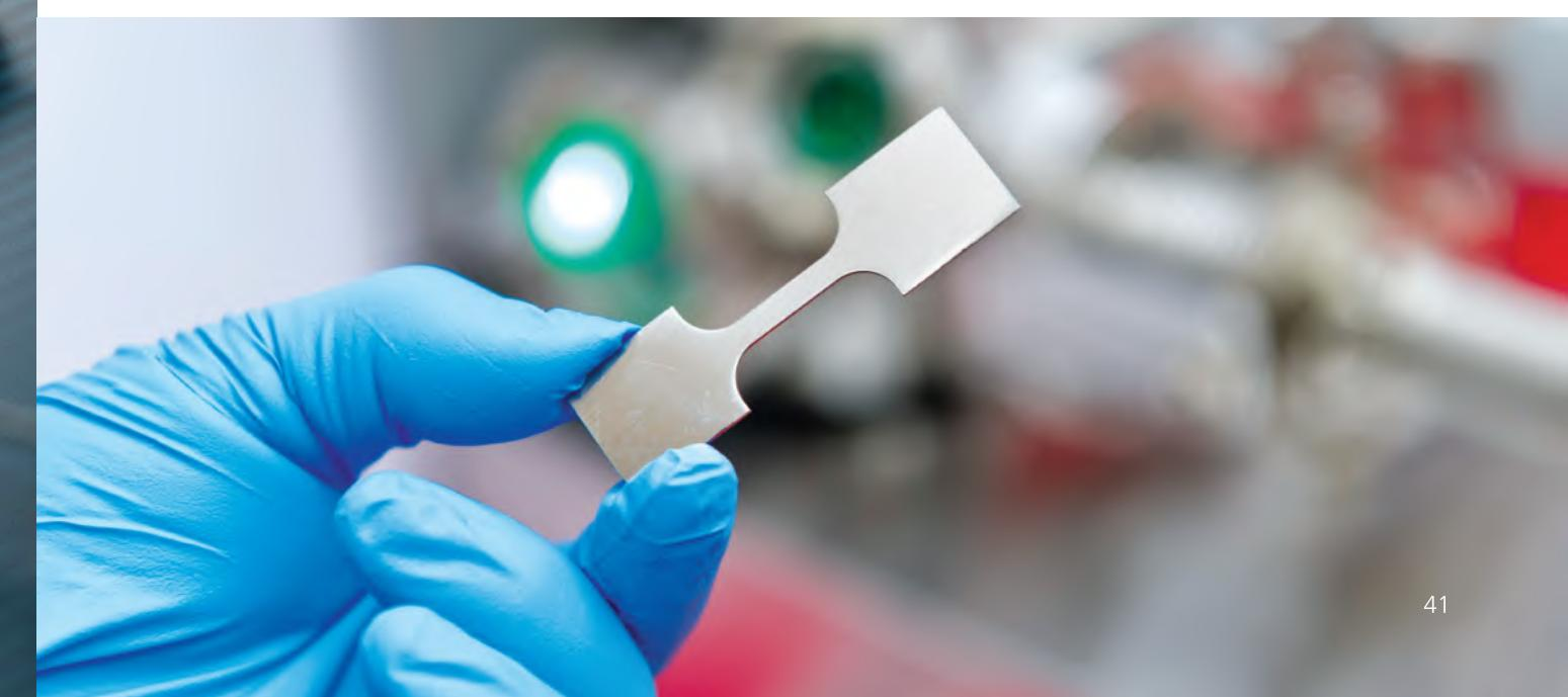
通过在一种金属间化合物合金中加入原子浓度为1.5-2.5的硼后，研究人员发现合成的合金中有序堆积的晶粒之间形成了独特的纳米级层。该研究的第一作者杨博士表示：“这一纳米层在相邻晶粒之间充当了缓冲带，使晶界发生大面积塑性变形，从而在超高屈服强度水平下仍具有巨大的拉伸延展性。”
