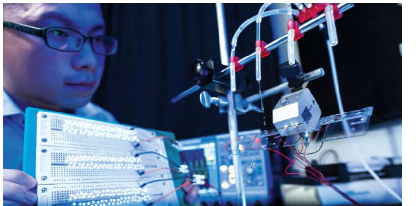
这款新型的液滴发电机,一滴水能产生超过140V电压,足以点亮100个小型LED灯。
